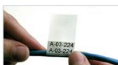
Breng het bedrukte gedeelte rond de draad aan.
